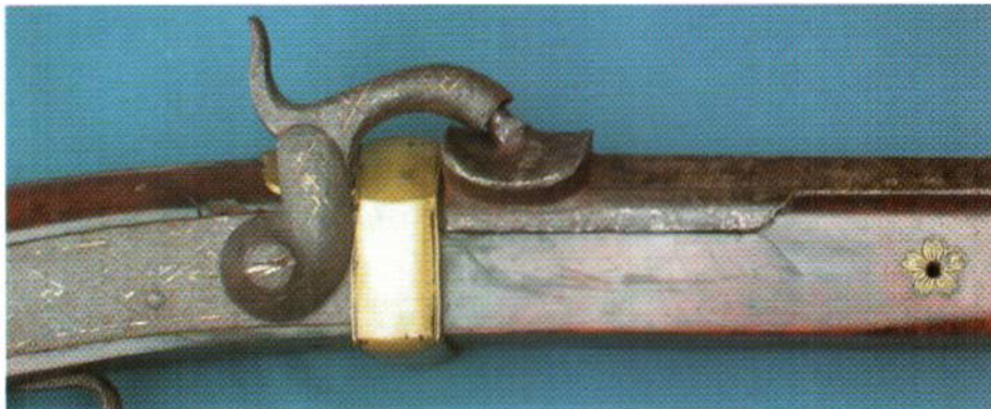
火縄式を管打式に改造した例
