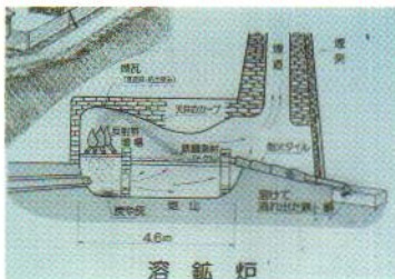
現地の反射炉説明図
