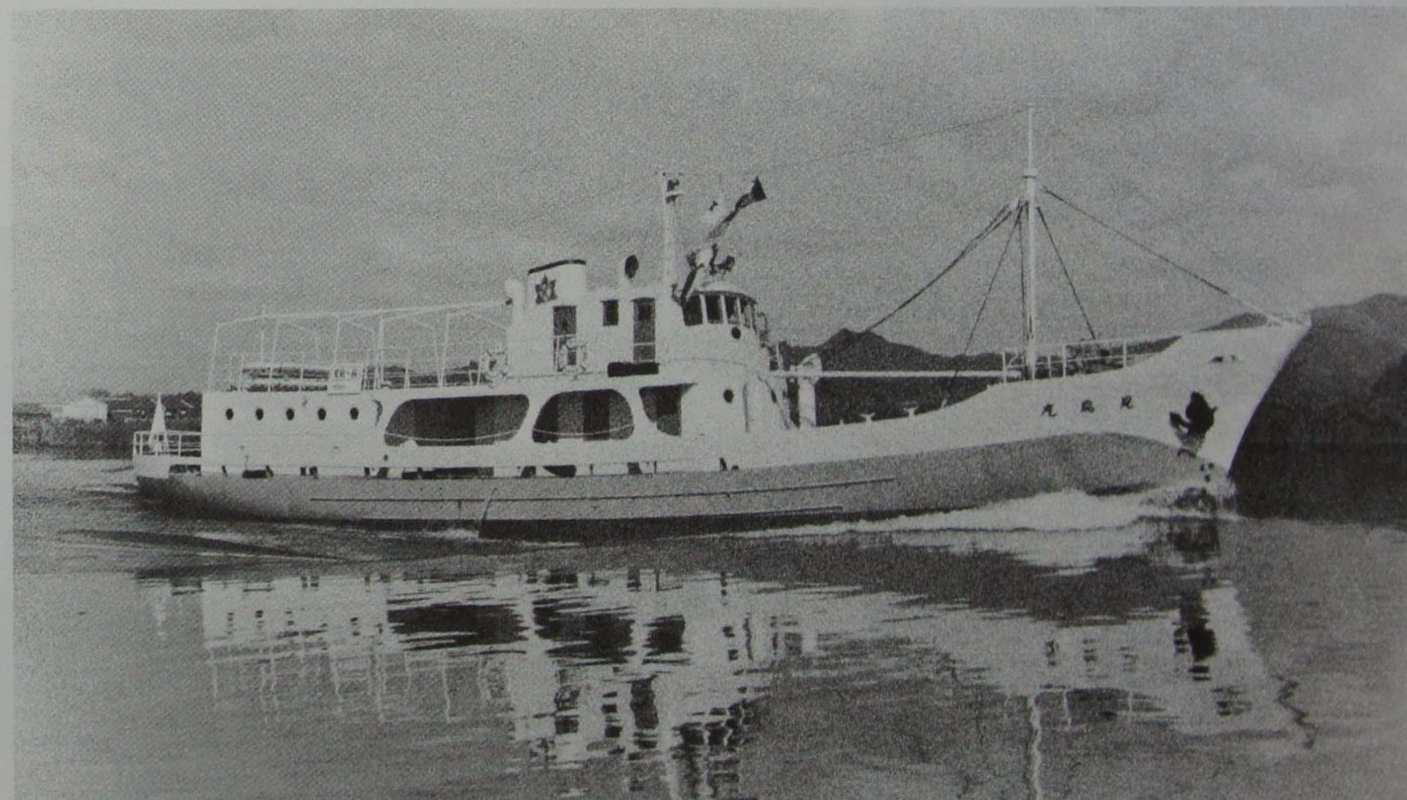
見島丸 萩-見島を結ぶ定期船 昭和34年10月進水 鋼船総トン数100トン 機関ディーゼル320馬力 速力11.5ノット 所要時間 2時間半 定員 50名 (萩海運株式会社経営)
