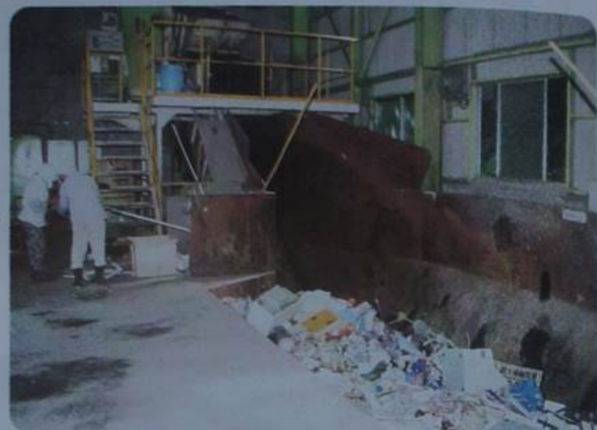
運ばれてきたごみは、はさい物コンベアに乗せられ、細かくくだかれます。
