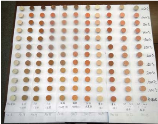
成分組成の異なる材料及び焼成温度の違いによる物性、色素等の比較検討状況
