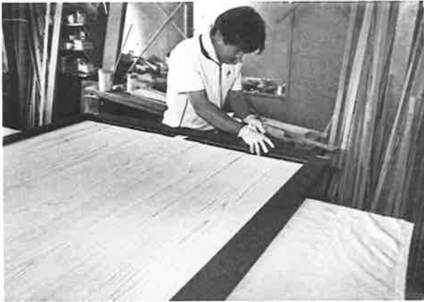
171. 新調舞良戸施工状況
