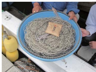
縄鉢 延縄を入れる鉢。フチの部分に針を引っかける。昔はワラを巻き固めたもの（ホテ）をフチに巻いて針をかけていた。
